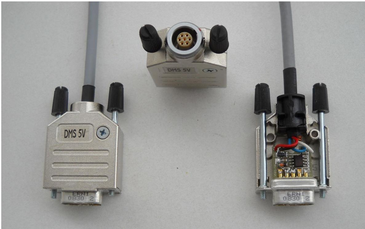
Dieser kompakte Miniatur Messverstärker eignet sich zur Verstärkung von DMS-Vollbrückensignalen mit typ.  $\pm 2\text{mV/V}$  auf  $0,5..4,5$  Volt ( $2,5 \pm 2\text{V}$ ). Für DMS Halb- oder Vollbrücken kann der Verstärker auch als Option mit eingebauten Ergänzungswiderständen geliefert werden.
