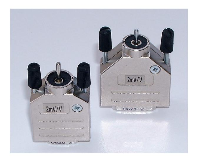
Dieser Kalibratorstecker dient zur Erzeugung von definierten mV/V –Signalen. Ausgehend von der Mittelstellung des Schalters (0mV/V) erzeugt er jeweils ein positives und ein negatives mV/V Kalibriersignal. Damit kann zum Beispiel die Messbereichseinstellung von Messverstärkern überprüft oder deren Eingangsempfindlichkeit ermittelt werden.
