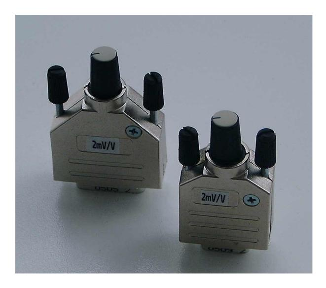
Dieser Simulatorstecker dient zur stufenlosen Simulation von mV/V Signalen. Damit kann zum Beispiel die Messbereichseinstellung von Messverstärkern überprüft werden oder die Eingangsempfindlichkeit ermittelt werden. Im Rahmen seiner Genauigkeit kann er auch zur Kalibrierung benutzt werden. Bei der Erstellung oder Überprüfung von Software zur Messwerterfassung kann er zur Simulation von Messwerten eingesetzt werden.
